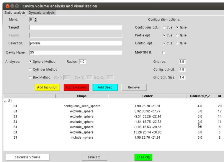
每个腔体定义通过名字（Given in the “Cavity Name” entry），可以创建包含、排除和种子形状使用“Add inclusion”, “Add Exclusion”, “Add Seed” 按钮。如果位置没有设置的很好，可以使用“Remove”按钮。可以通过在窗口双击隐藏形状。你可以在 VMD OpenGL 窗口查看起始格点位置。
